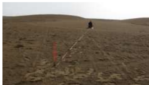
شکل ۲: موقعیت میله‌ها و اندازه‌گیری میزان جابجایی برخان نسبت به آن‌ها (طی سال‌های ۲۰۱۳-۲۰۱۹)
