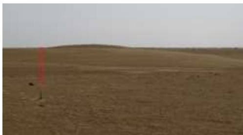
شکل ۲: موقعیت میله‌ها و اندازه‌گیری میزان جابجایی برخان نسبت به آن‌ها (طی سال‌های ۲۰۱۳-۲۰۱۹)
