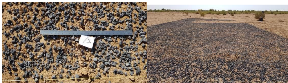
شکل ۲- تصاویری از پیاده سازی طرح و پاشش سرباره های فولاد مبارکه با تراکم های مختلف
