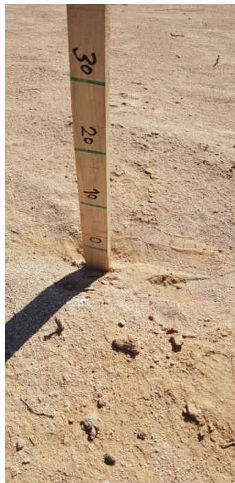
شکل ۷- شاخص چوبی مدرج نصب شده در عرصه به منظور اندازه گیری عمق بادبردگی
