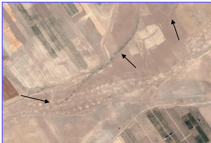
شکل ۷. شکاف‌های ناشی از فرونشینی سطح دشت.
